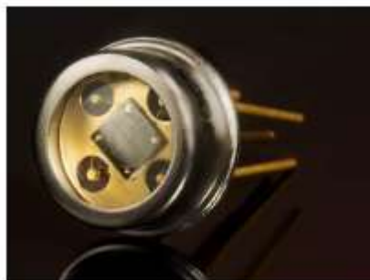
Рис 4 Внешний вид QD-фотодиода
