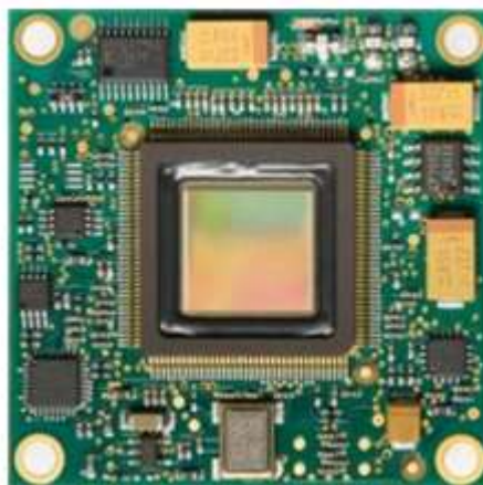
Рис 3 CMOS матрица фотокамеры
