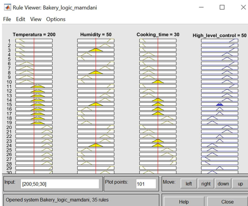
2-сурет - Rule Viewer терезесінде қалыпты режимді тексеру нәтижесі
