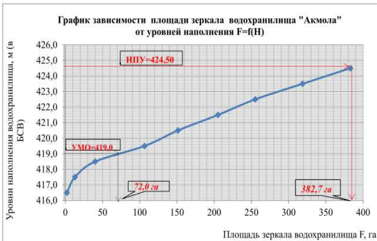
Рис.2 - График зависимости площади зеркала водохранилища "Акмола" от уровня наполнения F=f(H)
