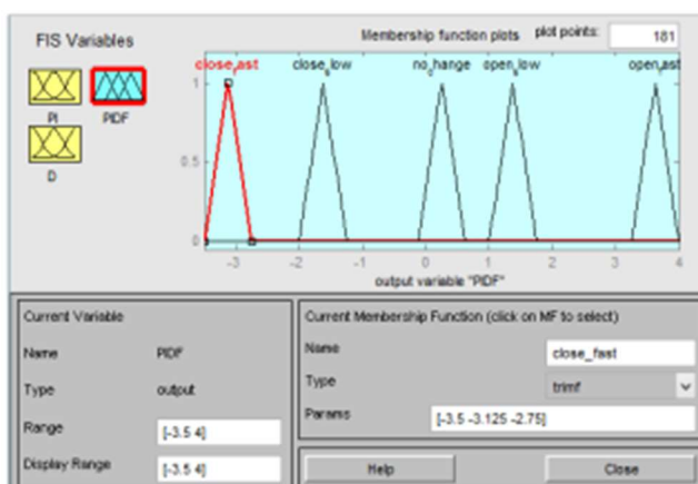
Рисунок 4 – Параметры функции принадлежности выходной переменной «PIDF»
