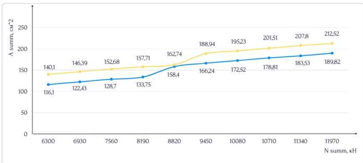
● 1 вариант компоновки ● 2 вариант компоновки N summ (кН) - Суммарная расчетная нагрузка A summ (см 2 ) - Суммарная поперечная площадь сечения продольных стальных элементов
