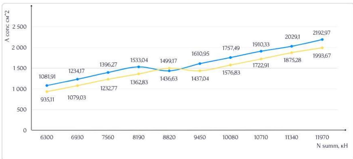
Рисунок 2 – График зависимости суммарной поперечной площади сечения продольных стальных элементов от суммарной расчетной нагрузки на колонну
