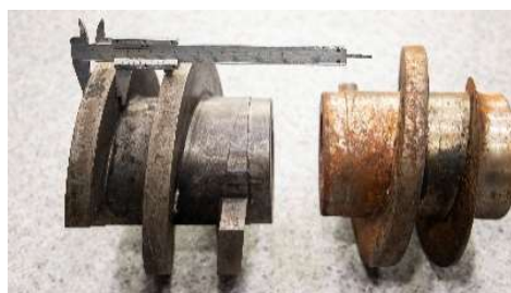
а) Износ шнека с исходной толщины 21 мм
