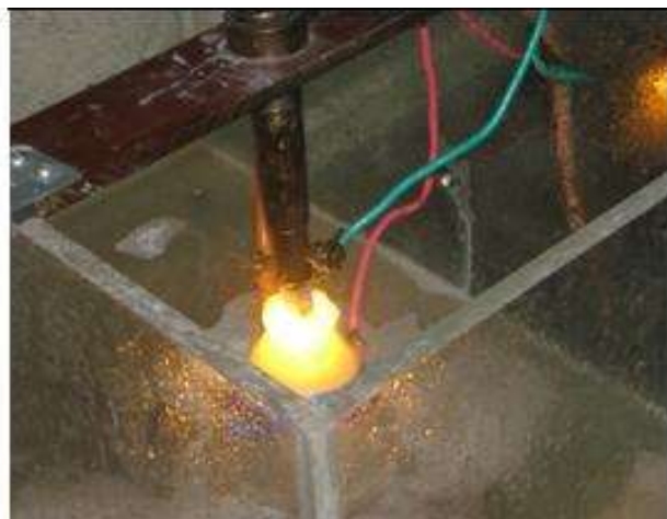
Рисунок 3- Электролитно-плазменная закалка стального образца шнека экструдера.
