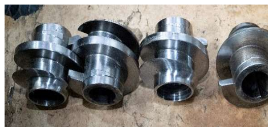
б) Одинаковый абразивный износ крайних сопрягаемых витков шнека
