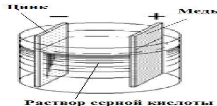
Рисунок 1 - Элемент Вольта (простейший химический источник тока)
