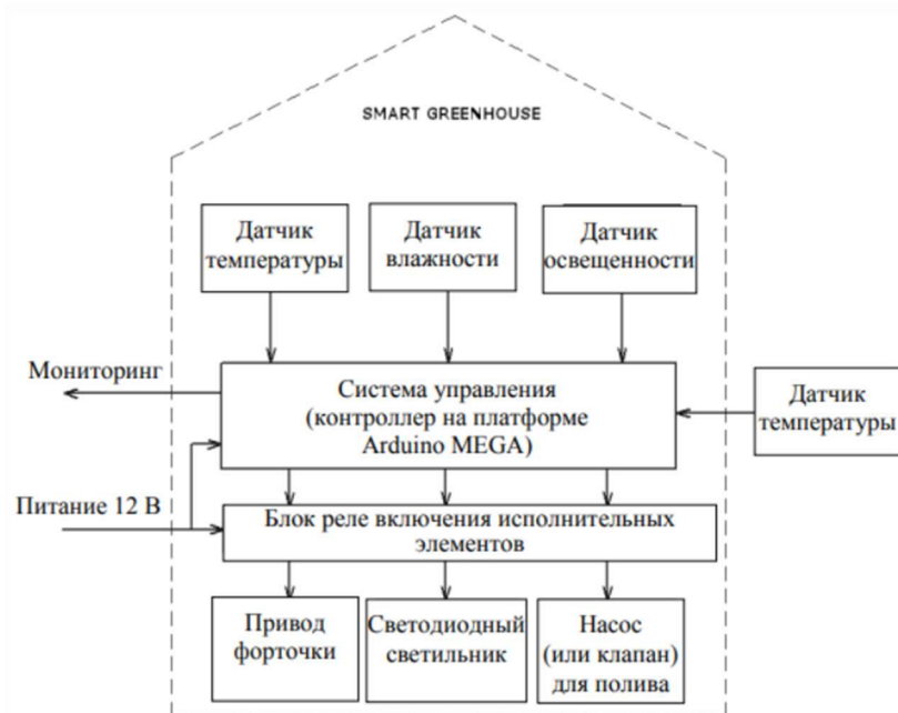
Рисунок 3. Предлагаемая. схема автоматизации микроклимата фермерской теплицы
