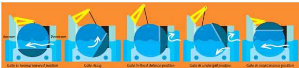
Рис. 5 - Схема работы Thames Barrier
