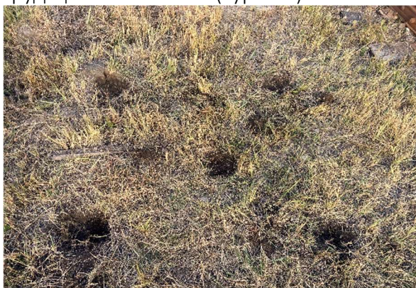
Сурет. 1. Әр түрлі функционалды аймақтардан репрезентативті үлгілерді алу үшін стандартталған әдістерді, соның ішінде квартильдік және конверттік әдістерді қолдана отырып, 15-20 см тереңдікте топырақ сынамаларын алу.
