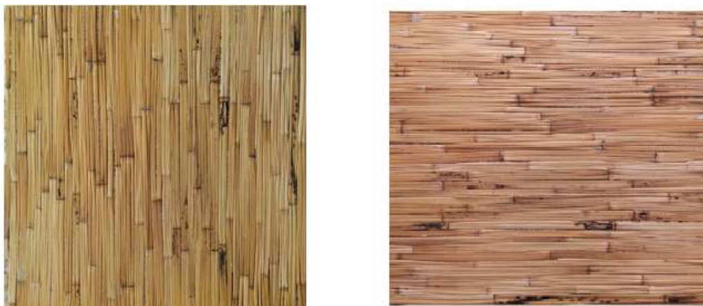
Рисунок 1. Образцы тростниково-слоистой фанеры с полиэтиленовой пленкой, склеенной нагревом и прессованием
