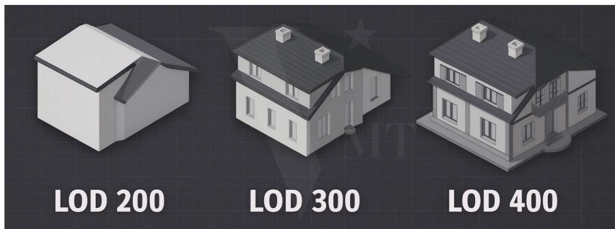
Рисунок 2. Прогрессия уровней детализации BIM-модели. ( https://vmts.ch/en/lod-300-in-archicad-precision-from-point-clouds-guaranteed-by-vmts/ )
