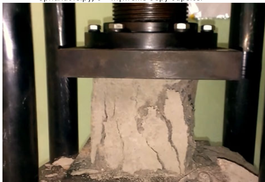
Сурет 5. Бетон үлгісінің сығу жүктемесі әсерінен бұзылу сипаты
