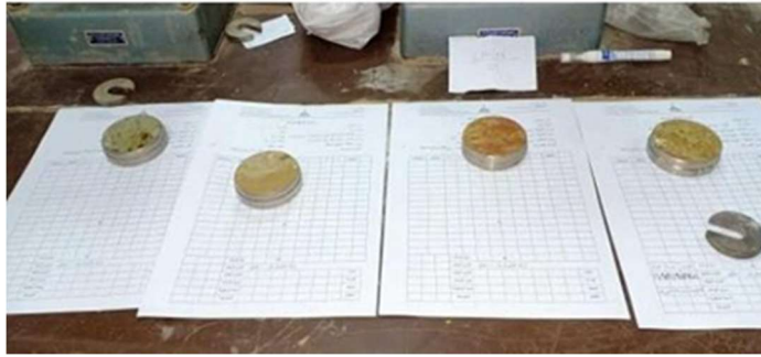
2-сурет. Одометр сақиналарында дайындалған ісінетін топырақ үлгілері
